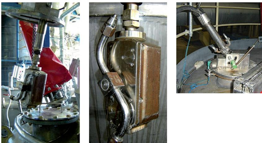
**Рисунок 6.** Подвижная распылительная головка для очистки реактора и резервуара. Устанавливается на свободном фланце и подключается к источнику подачи воды высокого давления. Распылительная головка вращается вертикально и горизонтально вокруг оси трубы.
