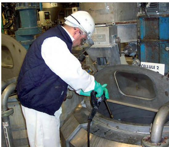
**Рисунок 8.** Очистка реактора горячей водой, очиститель высокого давления. При помощи форсунки для очистки трубопровода выполняется распыление вперед (1 струя) и назад (3 струи), шланг проходит через трубопровод вертикально вверх. Оператор должен быть оснащен средствами индивидуальной защиты от брызг горячей воды, подаваемой под высоким давлением.
