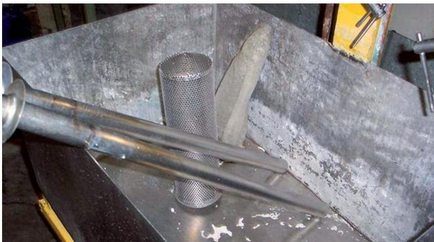
**Рисунок 7.** Рабочая станция для механической, ручной очистки («очистки щеткой») больших демонтированных частей оборудования.
