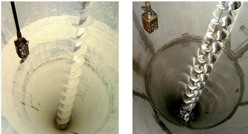
**Рисунок 5.** Внутренняя часть смесителя до и после влажной очистки с использованием вращающейся распылительной головки с последующей сушкой
