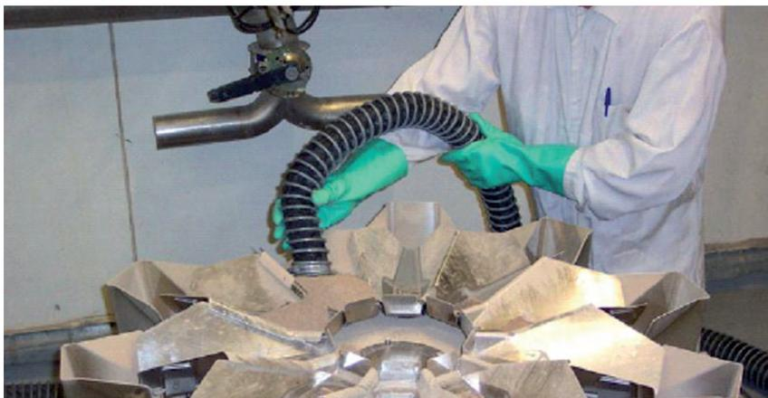
*Рисунок 9. Вакуумная очистка гранул из частично разобранного упаковочного оборудования с помощью специального промышленного вакуумного очистителя, оснащенного высокоэффективным воздушным фильтром для контроля за содержанием пыли.*
